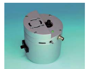
反射測定用 5Wハロゲン光源 内臓型 (内径50mm) 小型積分球 (360-2500nm, サンプルポート内径10mm)
