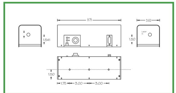
LS-PRO 外形寸法図 91.4(W)x247.7(L)x88.9(H)mm
