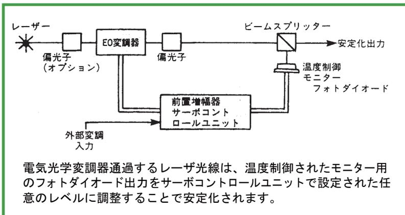
電気光学変調器通過するレーザ光線は、温度制御されたモニター用のフォトダイオード出力をサーボコントロールユニットで設定された任意のレベルに調整することで安定化されます。
