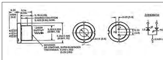
サーキュレーザ素子はマイクロレンズを組み込んだ高輝度の可視光レーザーで、しっかりと密封されたパッケージにより、高品質で信頼性の高い回折限界の丸いビームが得られます。NA:0.11 の 9mm 標準型
